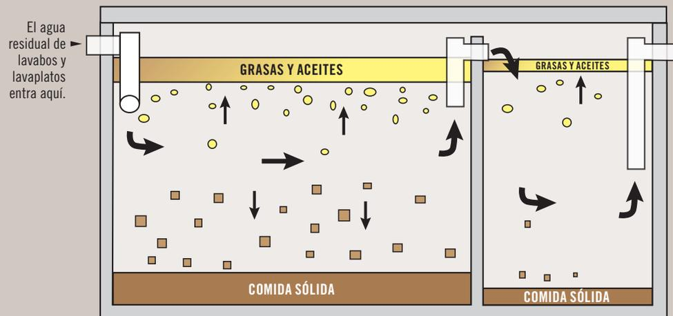
Los **interceptores de grasa** mantienen grasas, aceites y comida sólida en un tanque donde se asientan al fondo hasta que se los puede sacar. Esencialmente, las trampas de grasa y los interceptores de grasa funcionan de la misma manera y ambos mantienen grasas y aceites fuera del alcantarillado de la ciudad y el medioambiente.
